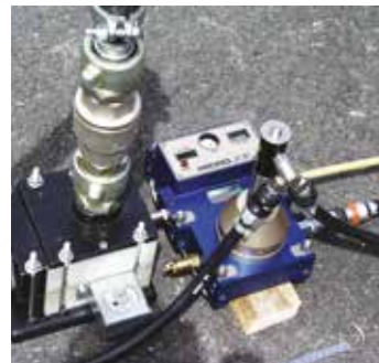
Dělení mikrotrubiček pro vedení optických vláken; přístroj pro zafukování optických mikrokabelů, autor: Metropolnet
